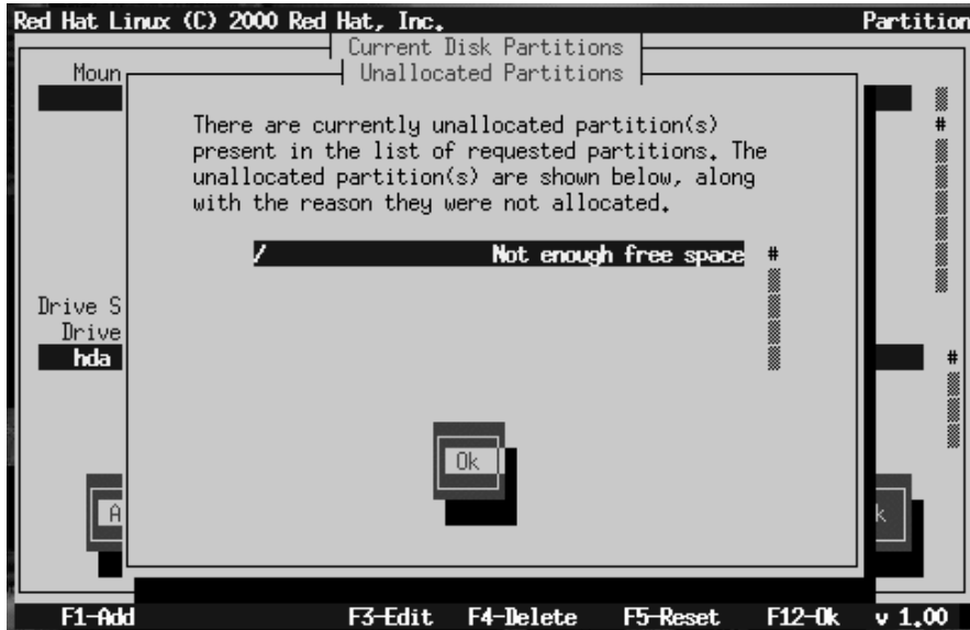
Figura 14–17 Finestra di dialogo delle partizioni non allocate
