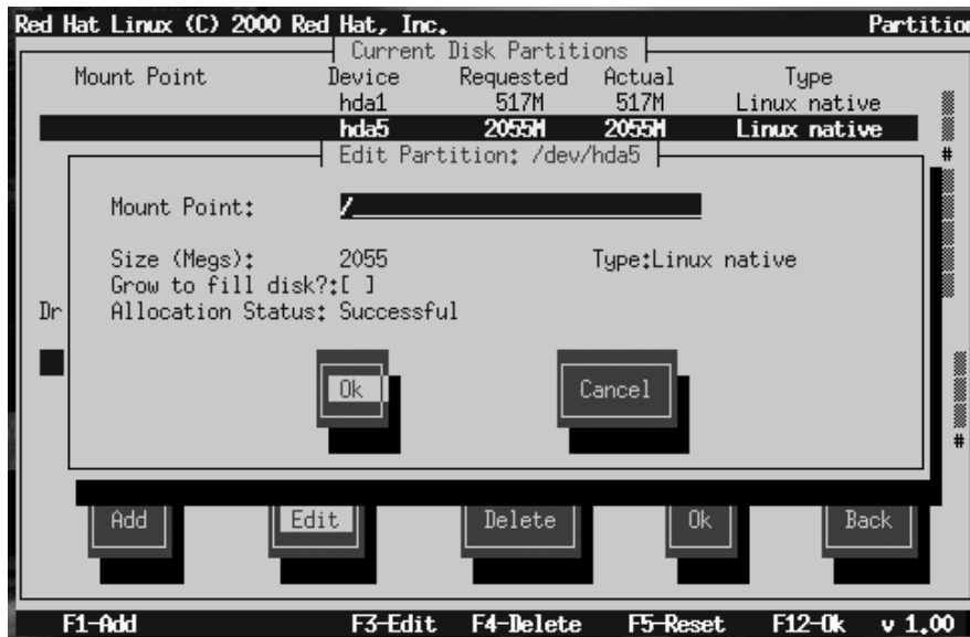
Figura 14–18 Modificare la finestra di dialogo relativa alla partizione
