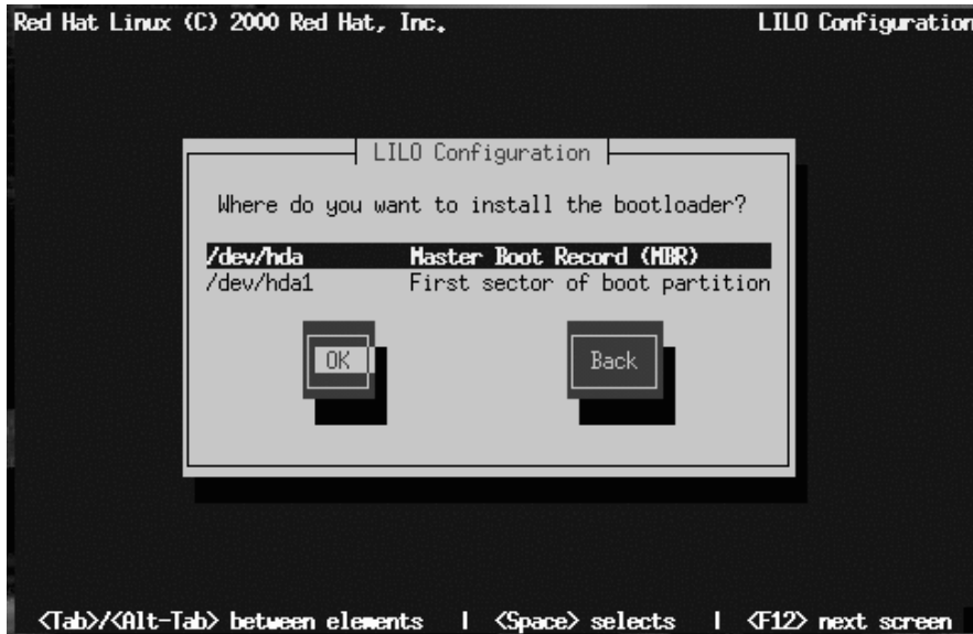
Figura 14–24 Installare LILO nella finestra di dialogo LIL0 Configuration
