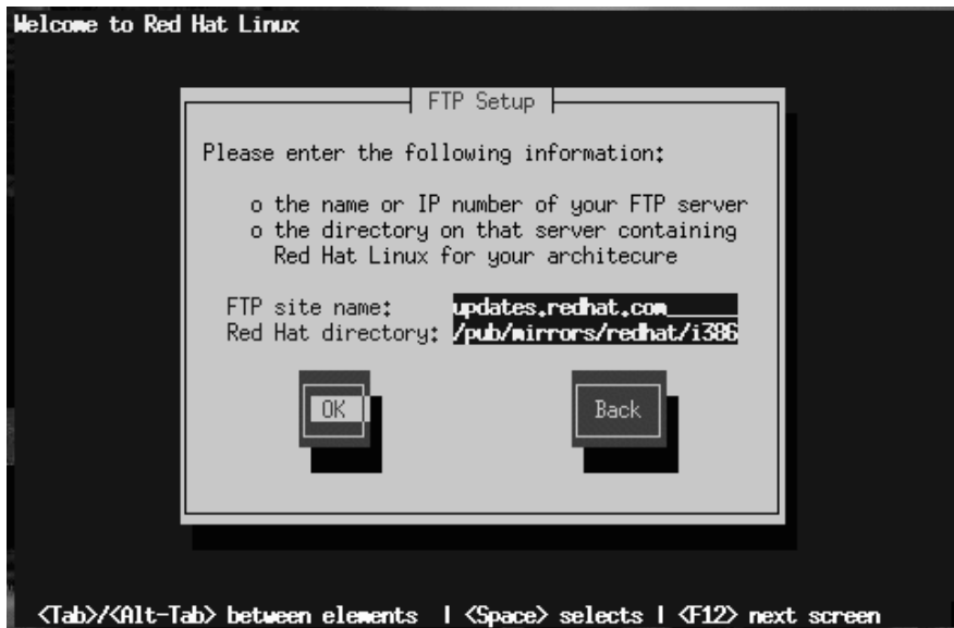
Figura 14–8 Finestra di dialogo setup FTP
