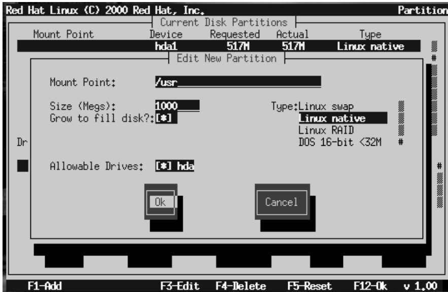
Figura 14-16 Modifica di una nuova partizione
